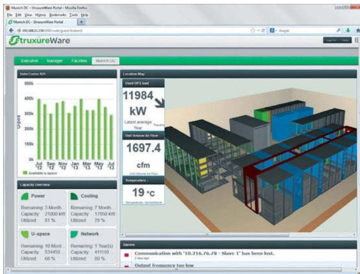
➤ **StruxureWare for Datacenter de Schneider colle aux processus ITIL tout en réconciliant la supervision de l'IT et celle des technologies de l'énergie et du refroidissement des équipements.**
